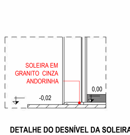
DETALHE DO DESNÍVEL DA SOLEIRA
